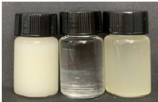
图 6 尿素对 IALA 的溶解作用 Figure 6 IALA dissolved by urea.
